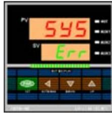
上显示窗显示“SYS”, 下显示窗显示“Err”
