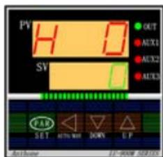
在正常状态下按住◀键3秒放开，进入程序设定状态，上显示窗(PV)显示“H0”符号，下显示窗(SV)显示当前设定值。
