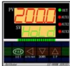
下显示窗(SV)显示“HoLd”符号，表示现在程序暂停执行，可通过按▲或▼键启动程序。
