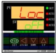
按住落(PAR)键 3 秒放开, 进入参数设定状态, 上显示窗 (PV) 显示第一个参数“Loc”符号, 下显示窗 (SV) 显示该参数当前值。可通过按▲▼键修改闪烁位的数值。
