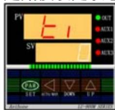
按一下(PAR)键立即放开, 进入起始时间设定状态, 上显示窗 (PV) 显示参数“ti”符号, 下显示窗 (SV) 显示该参数当前值。可通过按▲▼键修改闪烁位的数值。
