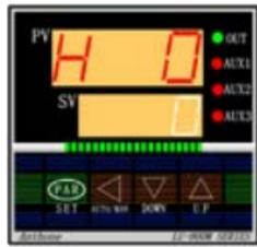
按一下(PAR)键立即放开，上显示窗(PV)仍显示“H0”符号，下显示窗(SV)出现闪烁数位，可通过按▲▼键修改闪烁位的数值。修改后，按一下(PAR)键确认，则下显示窗(SV)的显示值停止闪烁。
