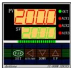
上显示窗 (PV) 显示测量值, 下显示窗 (SV) 显示状态由参数“LdiS”的设置值决定。
