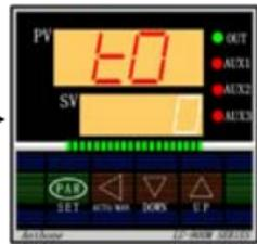
按一下(PAR)键立即放开, 进入起始时间设定状态, 上显示窗 (PV) 显示参数“t0”符号, 下显示窗 (SV) 显示该参数当前值。可通过按▲▼键修改闪烁位的数值。
